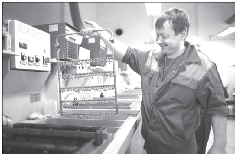
**В гальваническом цехе изделия покрывают родием, золотом, серебром.**
